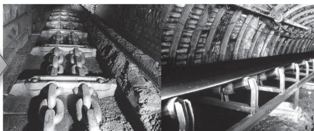
Лишь в первой половине 20 века труд рабочего-саночника постепенно заменяется скребковыми конвейерами, а ручная и конная откатки – электровозами и ленточными конвейерами. На открытых разработках основным видом технологического транспорта становится автомобильный транспорт.
